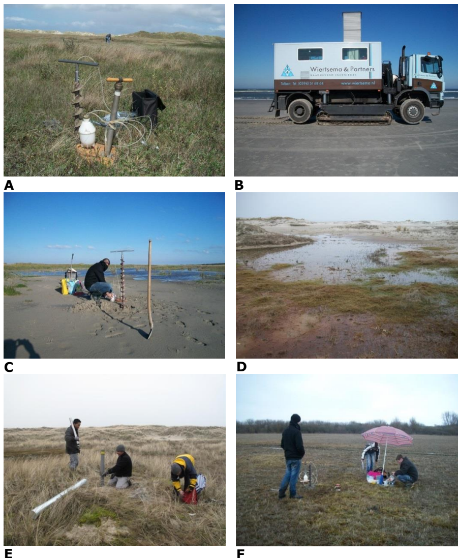
Figuur 3.5. Impressies van het veldwerk (foto's: P. Stuyfzand, m.u.v. E: door A.P. Grootjans). A = Spiraalboring op Borkum; B = sondering op Schiermonnikoog; C = spiraalboring op Groene strand Schiermonnikoog; D = periodiek duinmeertje met exfiltratie ijzerrijk grondwater op voorgrond, De Hors (Texel); E = plaatsing van peilbuis op De Hors (Texel); F = spiraalboring op noordpunt Veermansplaat.
